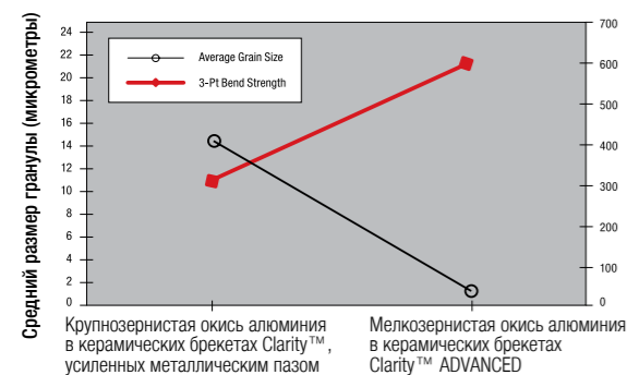
Рис. 2. Сравнение прочности материалов, используемых при изготовлении брекетов Clarity™ и Clarity™ ADVANCED
