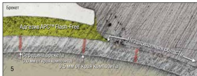
**Рис.5.** Кросс-секционная оценка микротвердости бычьего зуба с брекетом, зафиксированным на адгезив APC™ Flash-Free.
